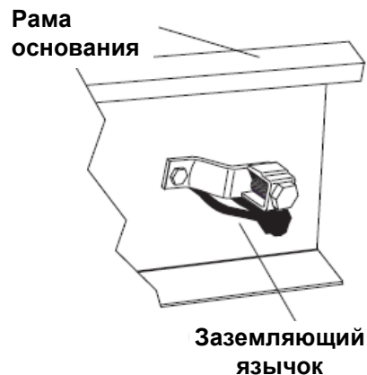
Рисунок 2.2. Заземляющий язычок генератора (типовой)
